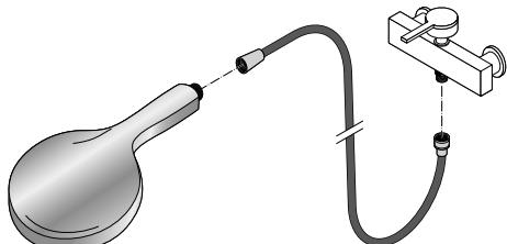
2. Schrauben Sie das Schlauchende mit der Rändelmutter an die Armatur und das Schlauchende mit dem länglichen Schraubstück an den Duschkopf.
