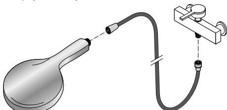
2. Końcówkę węża z nakrętką radełkową przykręcić do armatury, a końcówkę z podłużną złączką do słuchawki prysznicowej.
