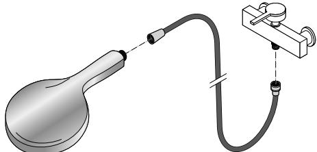
2. Vissez l'écrou moleté du flexible au robinet et l'extrémité conique au pommeau de douche.
